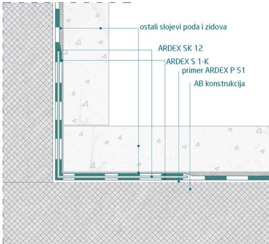
**ARDEX S 1-K**, premium austrijskog proizvođača ARDEX, je jednokomponentna disperzija sa specijalnim aditivima spremna za upotrebu, bez miješanja, sive ili žute boje. U sastavu nema razređivača.
